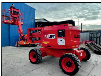
**13** Для спуска в аварийном режиме удерживайте необходимый тумблер на одной из панелей управления и опускайте стрелу.
